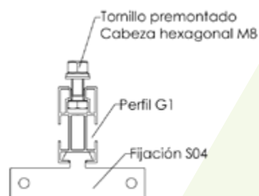
04.1H Disposición de los módulos en horizontal
