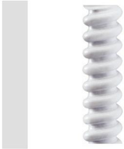
Sistema de tubos flexibles serie DF LIGHT en PVC, con clasificación 1311. En conformidad con las normas IEC 61386-1 e IEC 61368-23. La gama se compone de tubos en 4 diámetros, de 12 a 25 mm en color gris. Idoneos para la protección de cables en instalaciones fijas o móviles para aplicaciones no severas. Tipología de instalación: a la vista en pared y techo.
