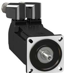
Servo motor BMH - IEC 070 mm - 1,2 Nm - 8000 rpm -eje liso -con freno -doble conector acodado orientable -encoder abs MT 128b SinCos -IP54
