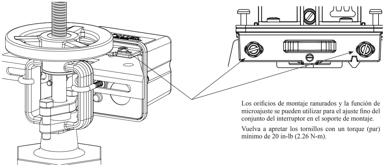
Los orificios de montaje ranurados y la función de microajuste se pueden utilizar para el ajuste fino del conjunto del interruptor en el soporte de montaje.
