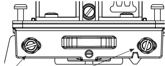
Los orificios de montaje ranurados y la función de microajuste se pueden utilizar para el ajuste fino del conjunto del interruptor en el soporte de montaje. Vuelva a apretar los tornillos con un torque (par) mínimo de 20 in-lb (2.26 N-m).
