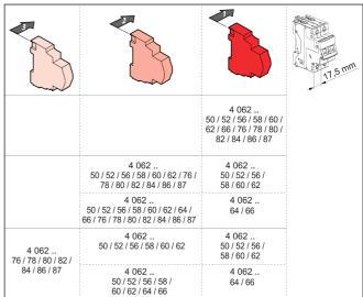
. For devices 1,5 modules per pole width:
