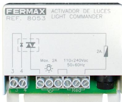
Para instalaciones que precisen de indicaciones de gran potencia cuando se recibe una llamada. Este equipo puede activar un timbre, una sirena o una bombilla cuando se presiona el pulsador de la llamada de la placa de calle. De reducido tamaño permiten su instalación en registros eléctricos. Se pueden empotrar en cajas estándar de 10x10 cm. Disponen de tiras adhesivas para su fijación, o bien, se pueden atornillar directamente a la pared.
