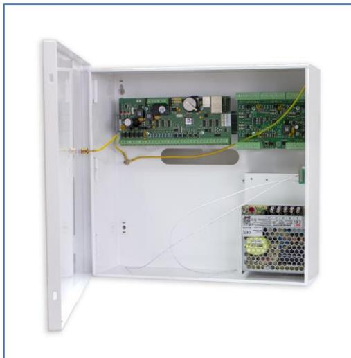
Kit de control de acceso para cuatro puertas. El kit consta de una caja metálica con fuente de alimentación, una unidad central IP y un expansor de E/S. Las puertas controladas pueden tener lectores de entrada Wiegand o de entrada / salida de huella FPAC-MAX (RS-485).
