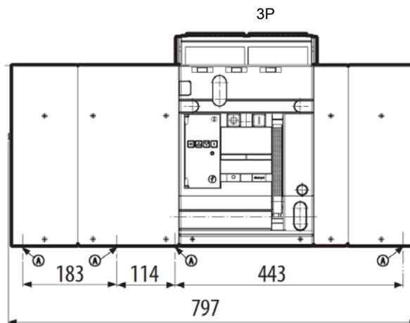
A = point de fixation sur platine de l'armoire
