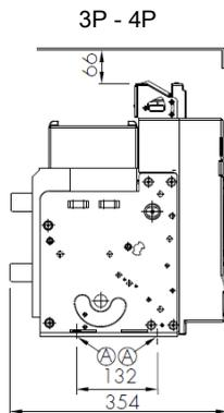
A = point de fixation sur platine de l'armoire
