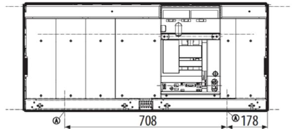
A = point de fixation sur platine de l'armoire
