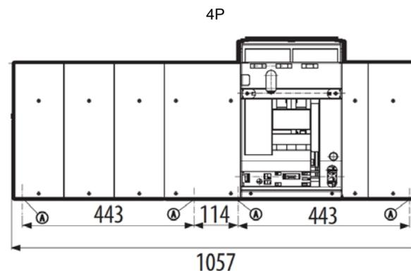
A = point de fixation sur platine de l'armoire
