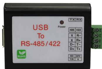
Interfaz que permite la conexión local entre el PC (puerto USB) y la instalación, pudiendo de esta forma configurar, controlar y gestionar las instalaciones.
