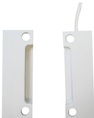
Instalación en superficie, entre la puerta y el marco. Cuando la puerta está cerrada al encararse las dos piezas por imantación se desliza una pletina interna que hace que los dos hilos entren en contacto. Cuando la puerta está abierta entre los dos hilos no hay continuidad. Para señalar o dar aviso de que la puerta está abierta o cerrado. Se conecta también a la entrada de sensor de puerta de nuestros sistemas de control de accesos.
